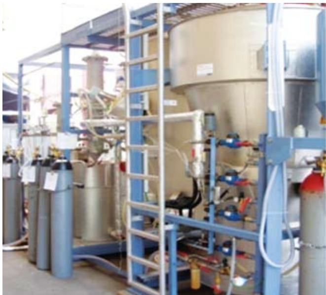
Planta piloto: Conversión continua de grasa animal en hidrocarburos en presencia de agua y de \text{Na}_2\text{CO}_3
