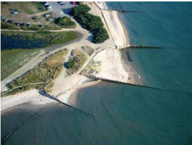
Figura 4: Campo de espigones para la protección costera
