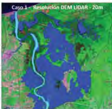
Modelos Digitales de Elevación de 20 y 50 m de resolución generados a partir de una nube de puntos LIDAR y malla de modelación utilizada con rugosidad variable.
