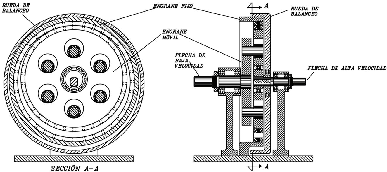
Fig. 2 Reductor de velocidad magnético del Instituto de Ingeniería
