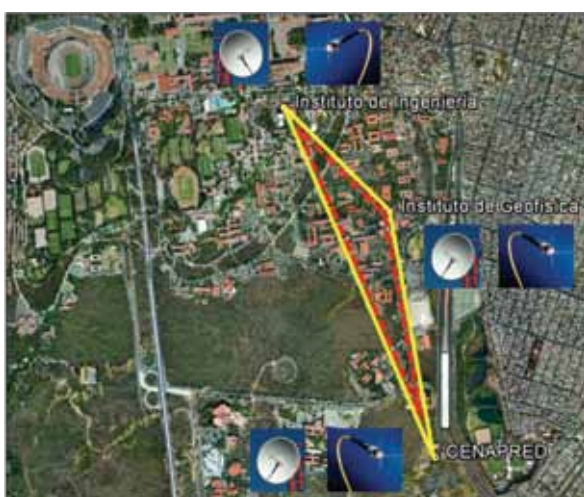
Figura 6. Sistema de doble delta de comunicaciones
