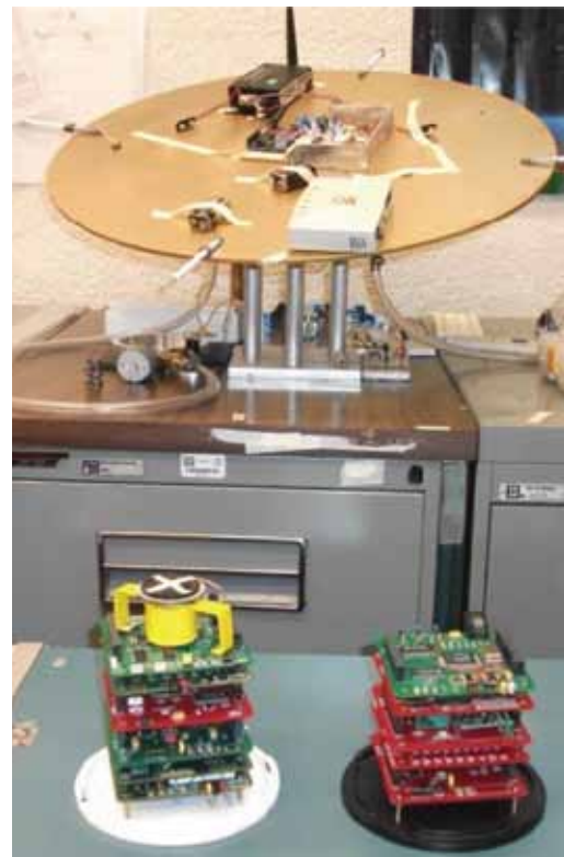
Validación de control de apuntamiento con MSA, HIL, instrumentada en nuestro laboratorio
