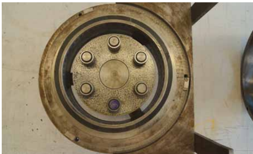
Figura 1. Ensamble parcial del reductor
