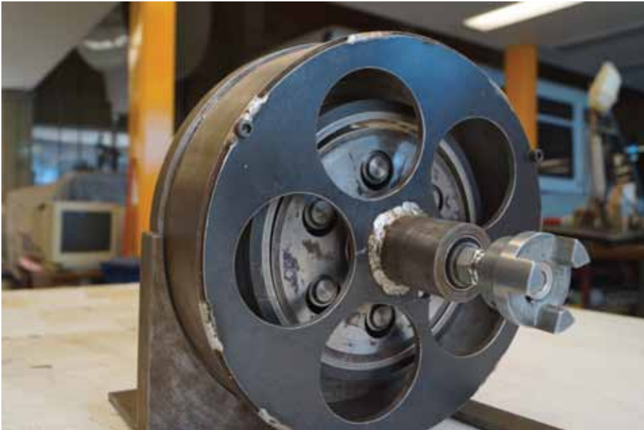
Figura 3. Prototipo de reductor de velocidad magnético
