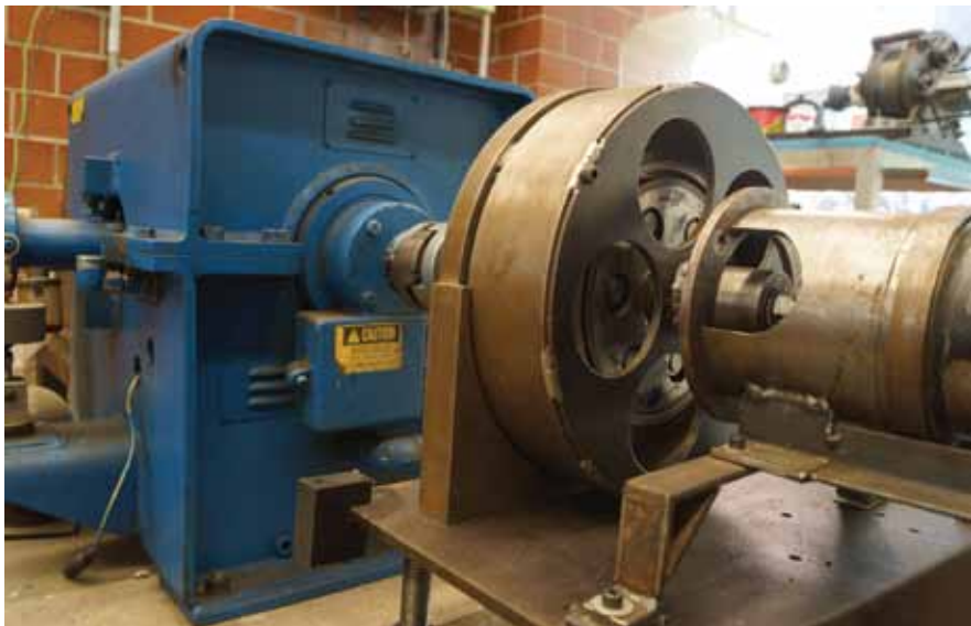
Figura 4. Prueba dinamométrica del reductor
