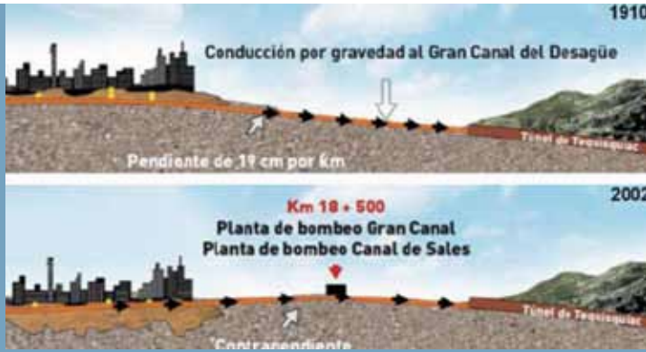
Reducción de la eficiencia hidráulica en los sistemas de drenaje, el gran canal (CONAGUA, 2007).
