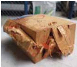
b) Cubo con fibras en posición vertical (falla frágil)
