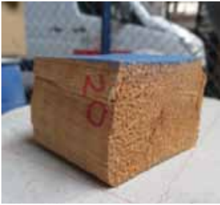
a) Cubo con fibras en posición horizontal (falla dúctil)
