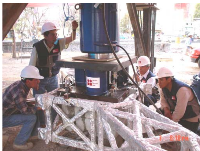
Fig. 4 Control visual, además del monitoreo con un sistema de adquisición de datos, de las variables internas de una pila durante el proceso de carga vertical
