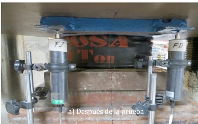
Figura 3. Celda de deformación de material polimérico.
