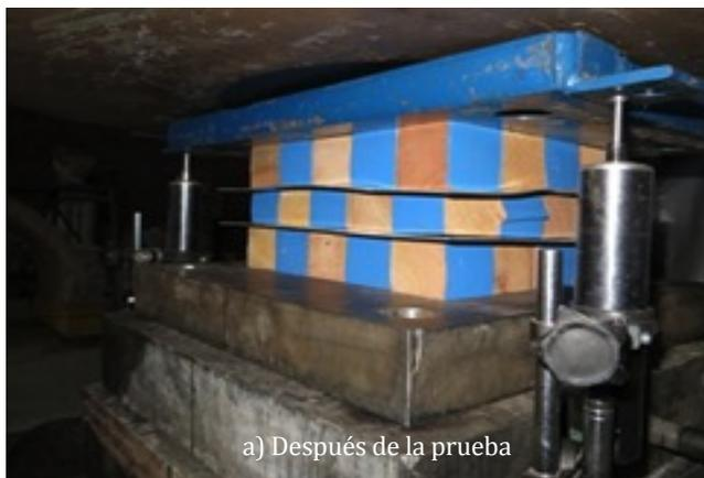
Figura 2. Celda de deformación de madera (tipo caobilla).
