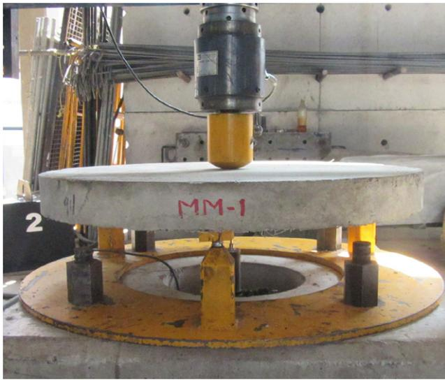
Figura 2. Ensayo a flexión en panel – ASTM C1550.
