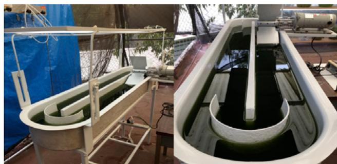
Figura 4. Cultivo de microalgas en reactor de circuito abierto conocido como RACEWAY
