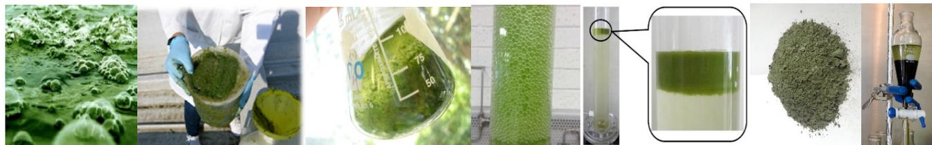
Figura 3. Extracción de lípidos a partir de biomasa de microalgas cultivadas en agua residual, cosechada mediante el proceso de ozoflotación
