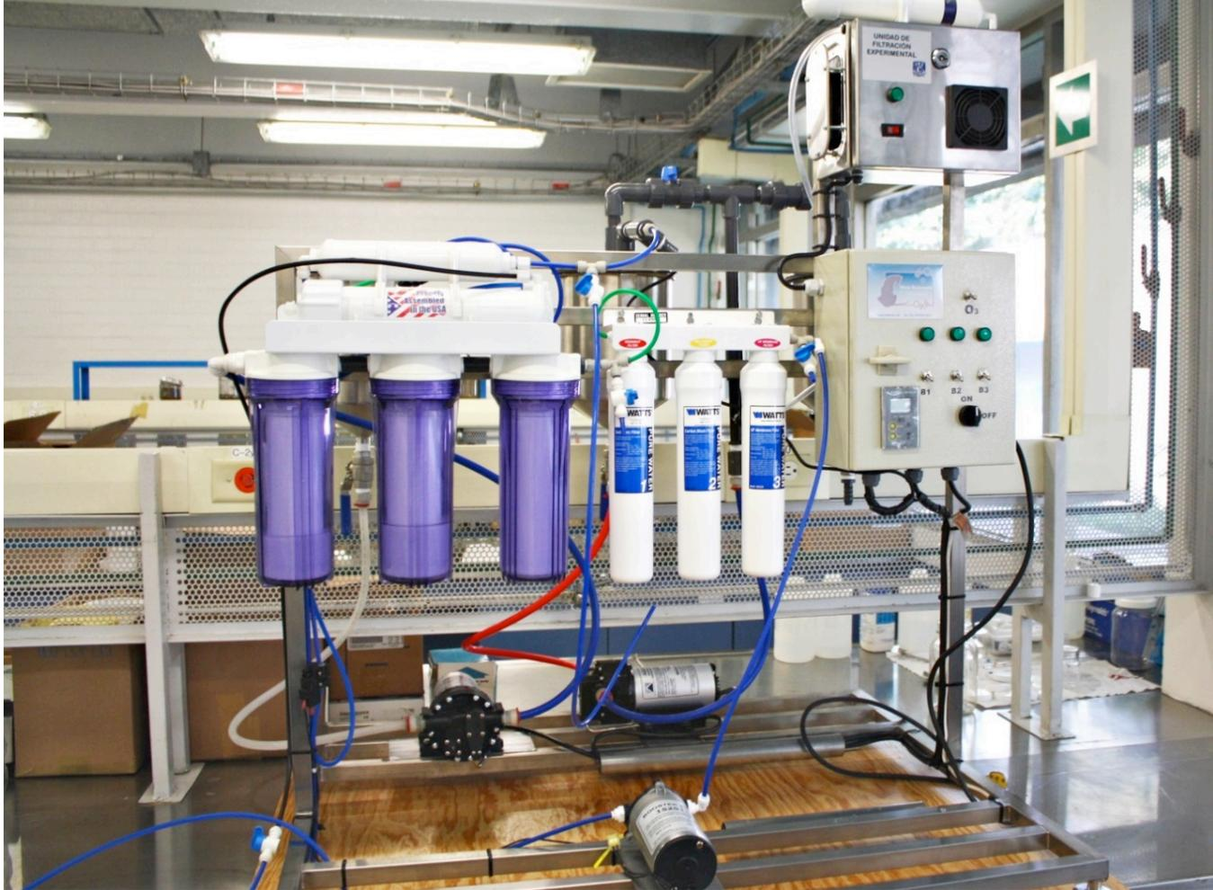
Figura 2. Planta piloto para evaluación de procesos de potabilización con múltiples barreras
