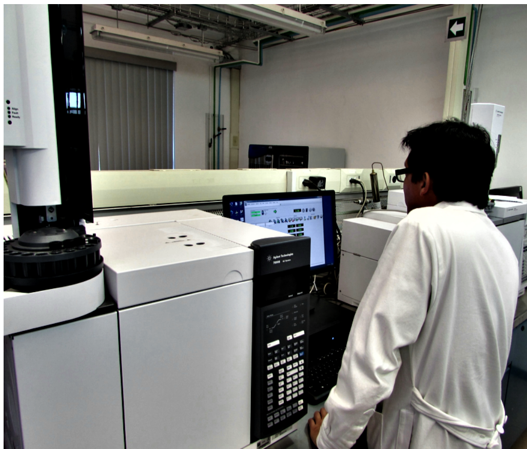
Figura 2. Equipos de cromatografía de gases para el análisis de los contaminantes en fase gaseosa
