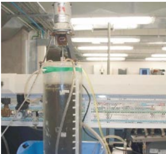
Reactor anaerobio/aerobio para tratamiento de compuestos nitroaromáticos
