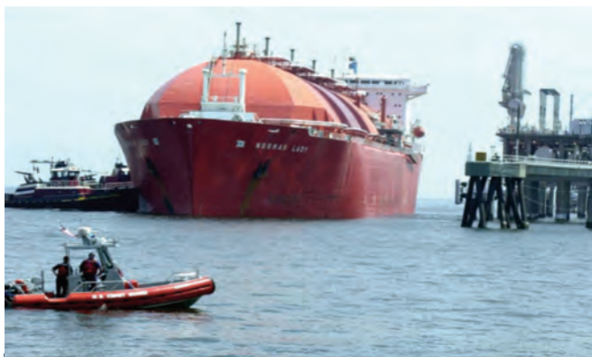
Buque tanque para el transporte de 57 mil toneladas de GNL [125 mil m 3 ] en esferas criogénicas a una temperatura de -160°C, en aproximación al muelle de descarga
