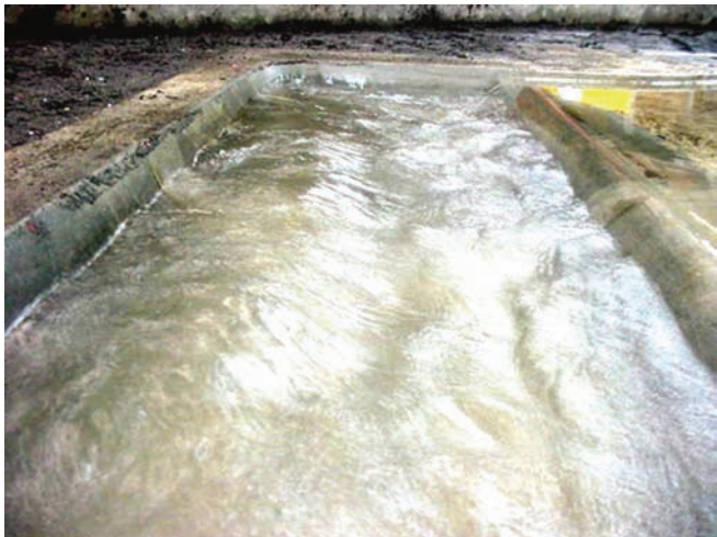
Estudio experimental de la obra de control sobre el río La Sierra, Tab
