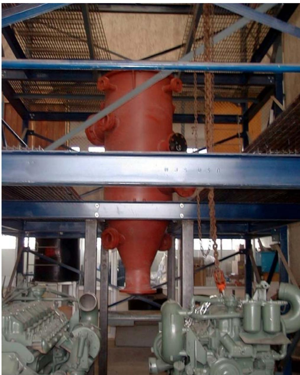
Gasificador que opera con biomasa para generar energía eléctrica
