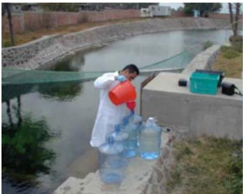
Muestreo para las pruebas de nanofiltración. Muestras de 240 l en 12 garrafones de 20 l
