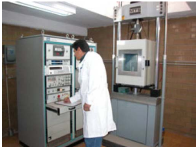
Ensayos dinámicos de concretos asfálticos bajo carga repetida y temperatura controlada
