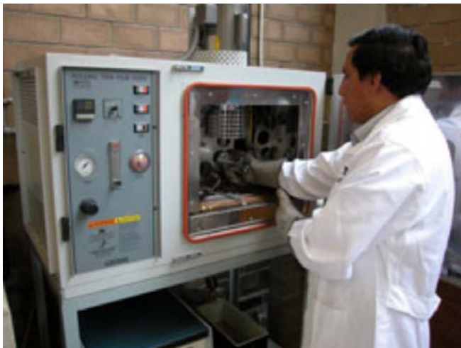
Prueba de película delgada rodada para estudiar el envejecimiento del cemento asfáltico
