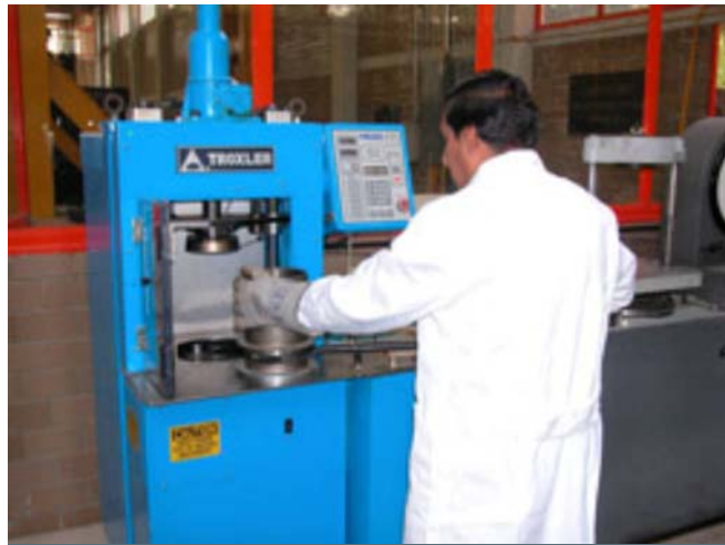
Compactador giratorio SHRP, compactando por amasado una probeta de concreto asfáltico
