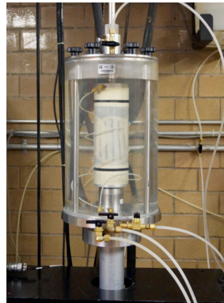
Figura 2. Prensa hidráulica con cámara triaxial para el estudio de materiales térreos para pavimentos
