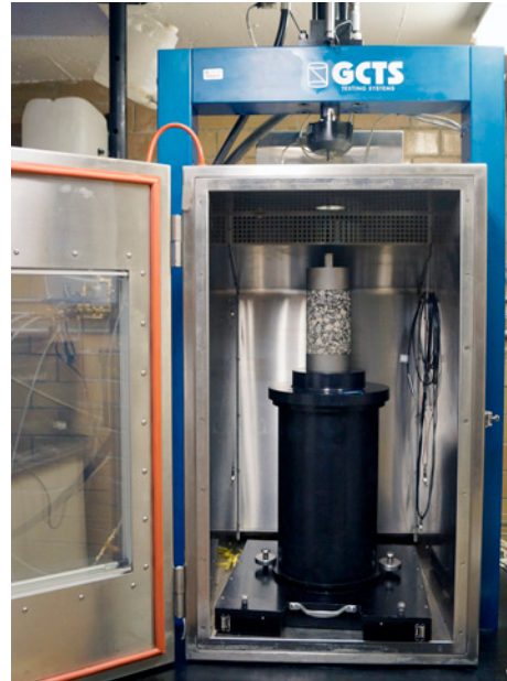
Figura 1. Prensa hidráulica con cámara térmica para el estudio del comportamiento mecánico del concreto asfáltico
