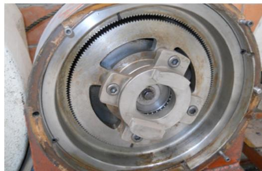
Figura 2. Transmisión cicloidal de engranes convencionales
