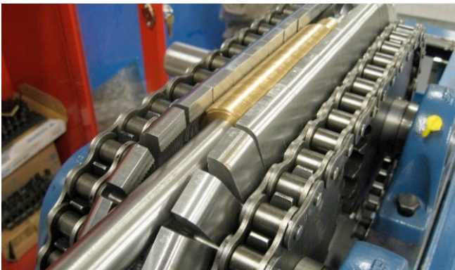
Figura 9. Tornillo de traslación convencional montado en el segundo prototipo de la segunda versión del reductor
