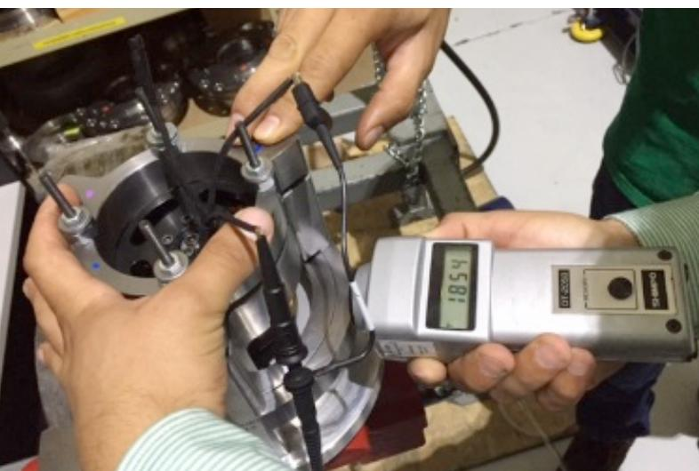
Figura 4. Registro de vibraciones de la microturbina
