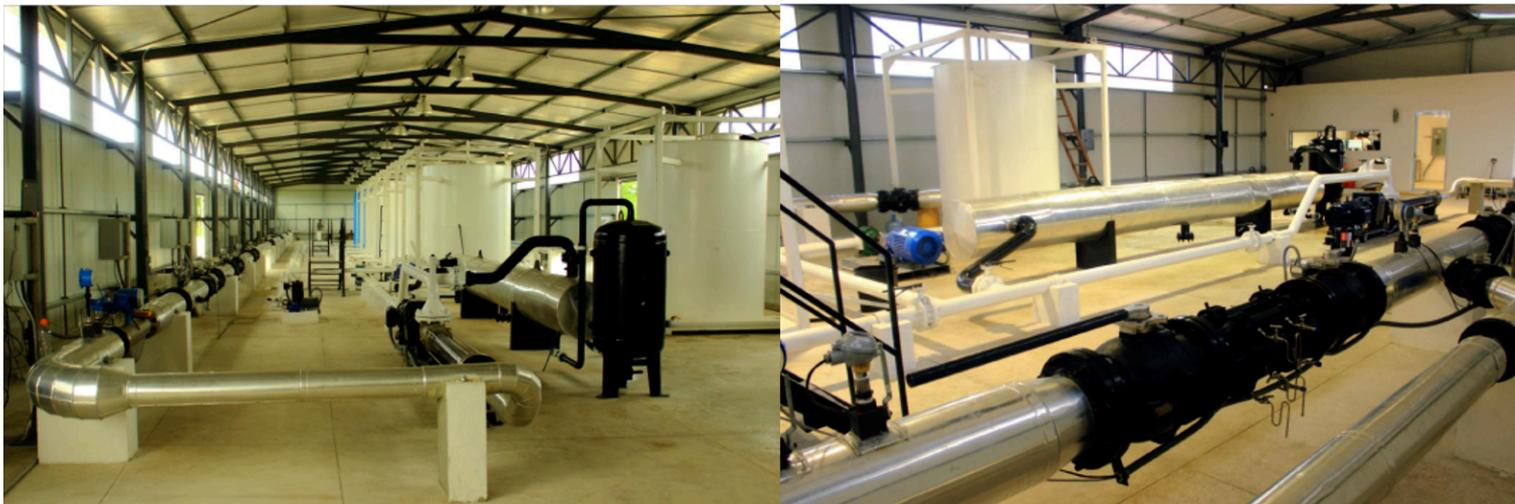
Figura 2. Circuito de 8" con tanques, bomba de cavidades progresivas, cambiador de calor y sección de toma de muestras compuesta por un haz de siete tubos de 1"
