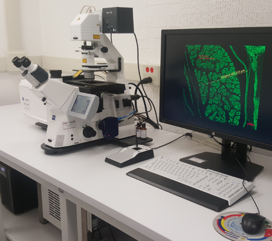
Figura 2. Microscopio confocal de barrido láser LSM-800 Marca Zeiss ubicado en el Laboratorio de Ingeniería Ambiental
