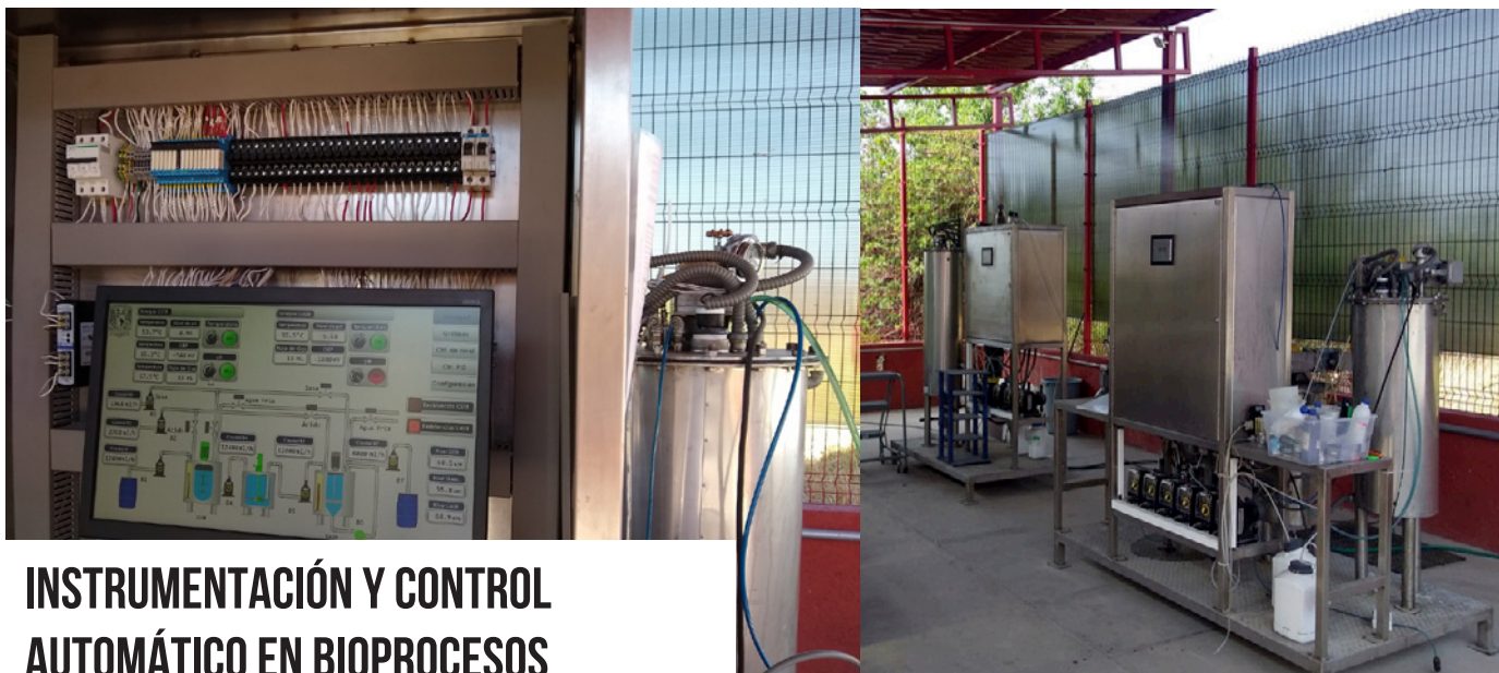
Figura 1. Sistemas anaerobios experimentales de tamaño relevante, controlados mediante un PLC industrial
