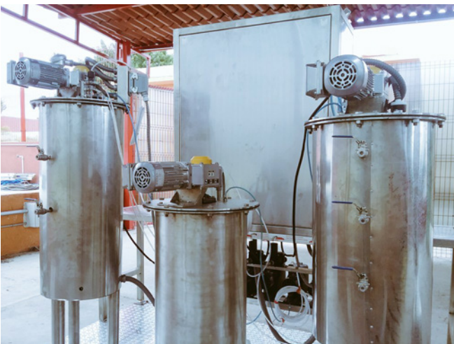
Figura 3. Reactores para el tratamiento en dos etapas de residuos de biorrefinería
