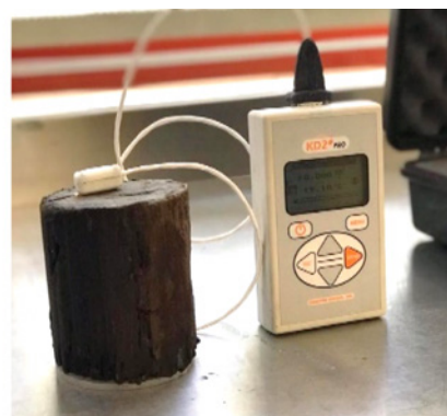
Figura 1. (a) Equipo de la aguja térmica, y (b) curva de ajuste para una prueba de aguja térmica
