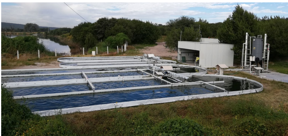
Figura 2. Sistema biotecnológico de escala industrial para el enriquecimiento (captura de \text{CO}_2 ) y desulfuración de biogás. Con permiso de Granos y Servicios Integrales S.A. de C.V. (GSI) y Proteína Animal S.A. de C.V. (PROAN)
