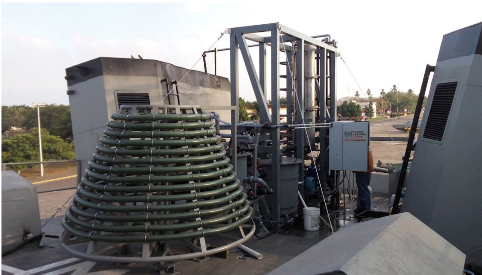
Figura 3. Prototipo para el tratamiento de gases de combustión (eliminación de \text{CO}_2 , \text{NO}_x y \text{SO}_x ) de embarcaciones oceánicas de la Secretaría de Marina Armada de México. Con permiso de la SEMAR
