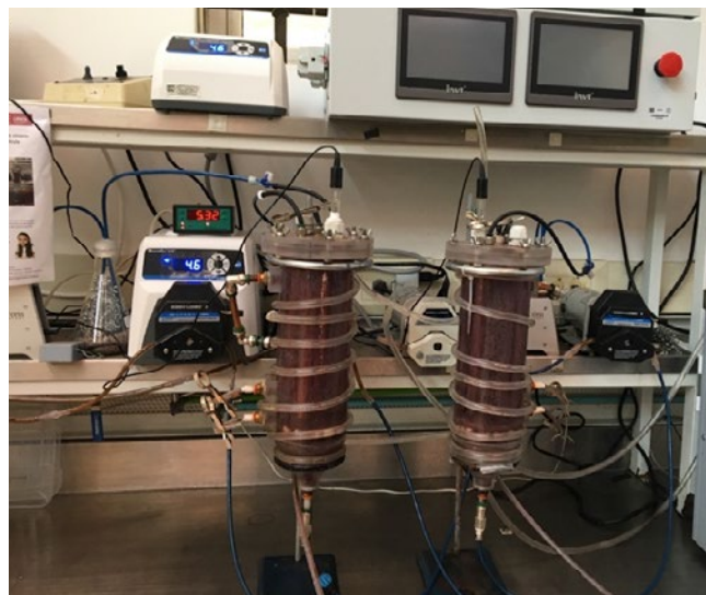
Figura 4. Reactores piloto de laboratorios instrumentados para la producción de hidrógeno
