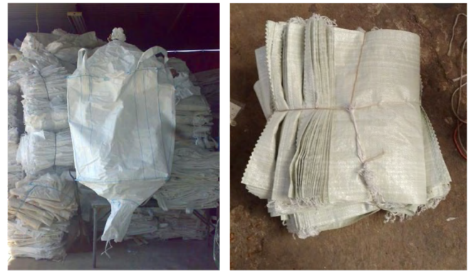
Figura 9. Big bag y costales de rafia, ambos residuos fabricados mediante el tejido de fibras sintéticas de polipropileno, al igual que algunas fibras comerciales que se adicionan a los concretos
