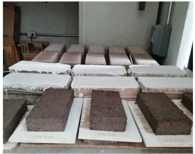
Figura 2. Fabricación de ladrillos y bloques con agregados reciclados
