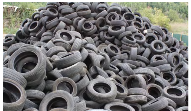
Figura 10. Neumáticos fuera de uso, su reciclado permite reutilizar el alambre de acero como subproducto para su uso como fibra de acero en el concreto
