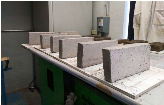
Figura 1. Fabricación de ladrillos con agregados reciclados y PET
