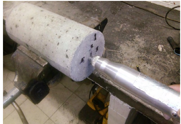
Figura 2. Distribución de puntos de aplicación del esclerómetro y forma de ejecución del ensayo
