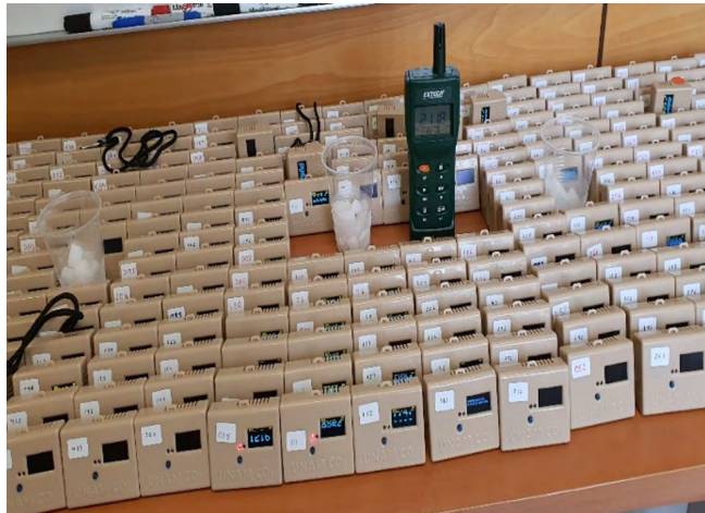
Figura 4. Verificación de los equipos utilizando hielo seco
