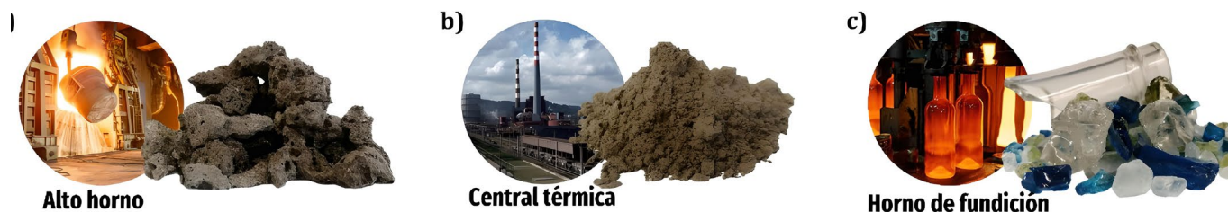
Figura 3. Residuos y subproductos industriales utilizados como precursores: a) escoria de alto horno, b) ceniza volante y c) residuos de vidrio. Fuente: propia y Wikimedia Commons
