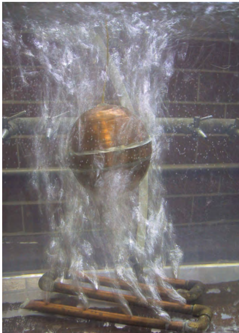
Fig 1. Vista del prototipo esférico durante una prueba experimental de determinación de pérdidas o ganancias de calor en los materiales de construcción
