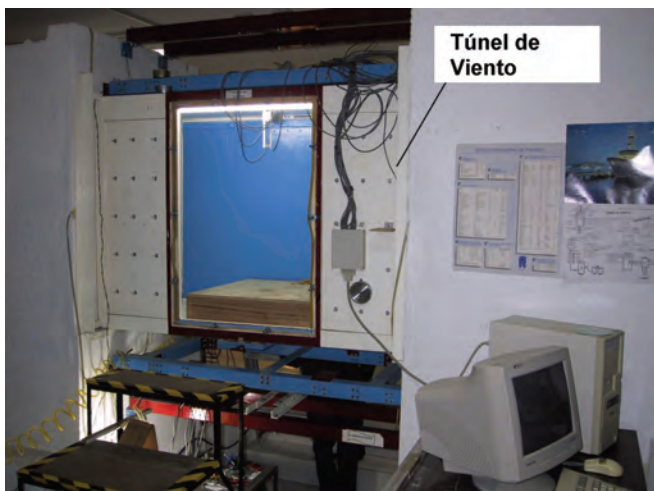
Fig 3. Vista del túnel de viento del Instituto de Ingeniería, UNAM, con su sistema de adquisición de datos
