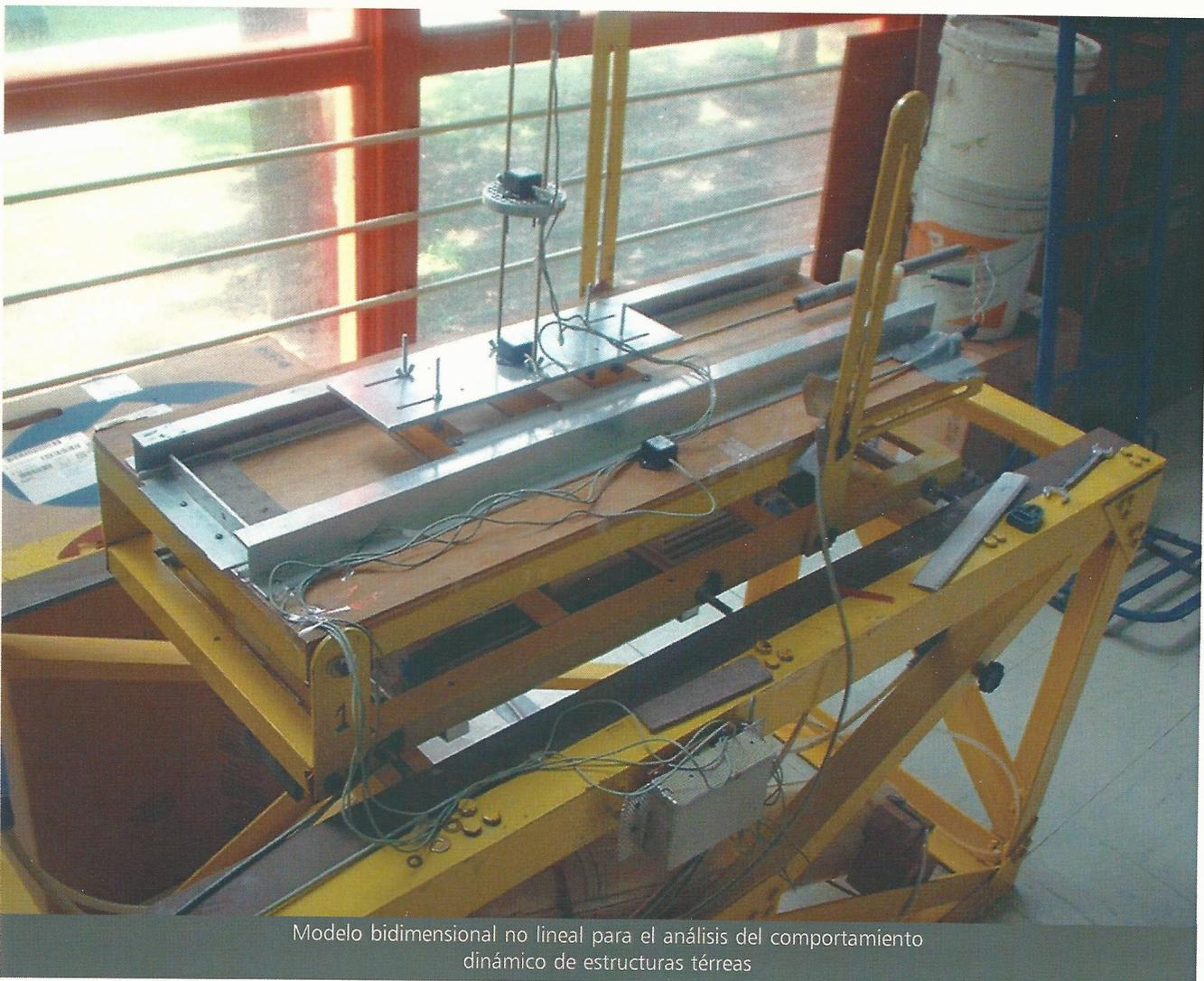
Modelo bidimensional no lineal para el análisis del comportamiento dinámico de estructuras térras
