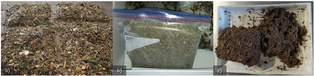
Figura 2. FORSU: a) cuarteo en sitio, b) empaquetado a -20°C, c) muestra extrudada
