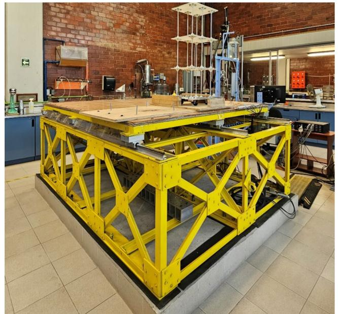
Figura 4. Mesa vibradora unidireccional servo hidráulica
