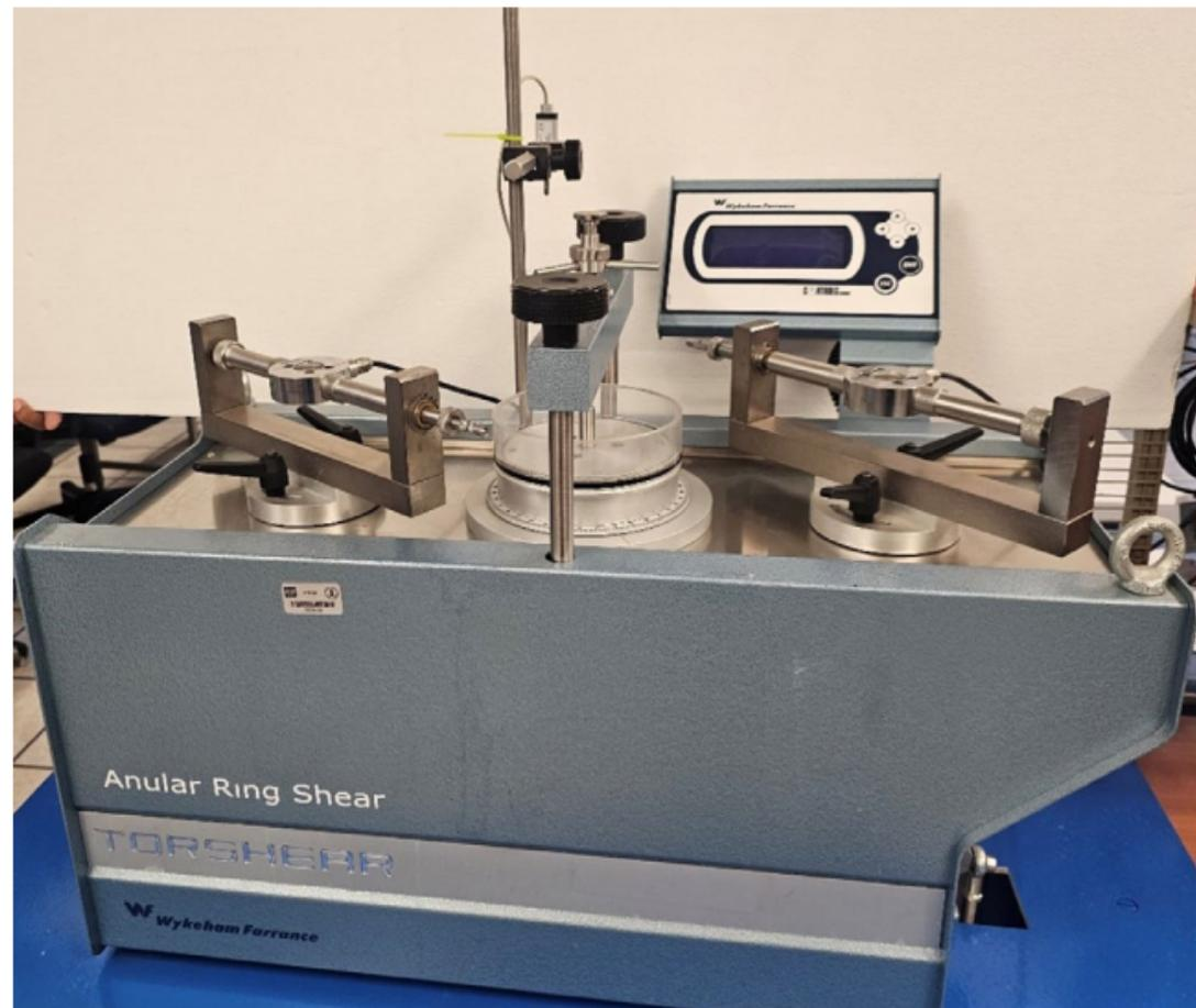
Figura 9. Equipo de corte para muestras remoldeadas, torshear
