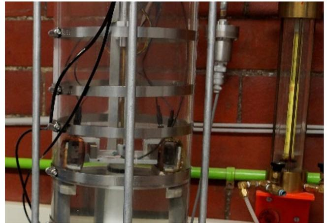
Figura 3. Equipo de columna resonante tipo Drnevich
