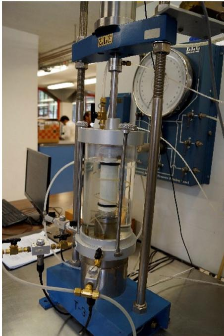
Figura 1. Equipo triaxial estático/cíclico, servo neumático
