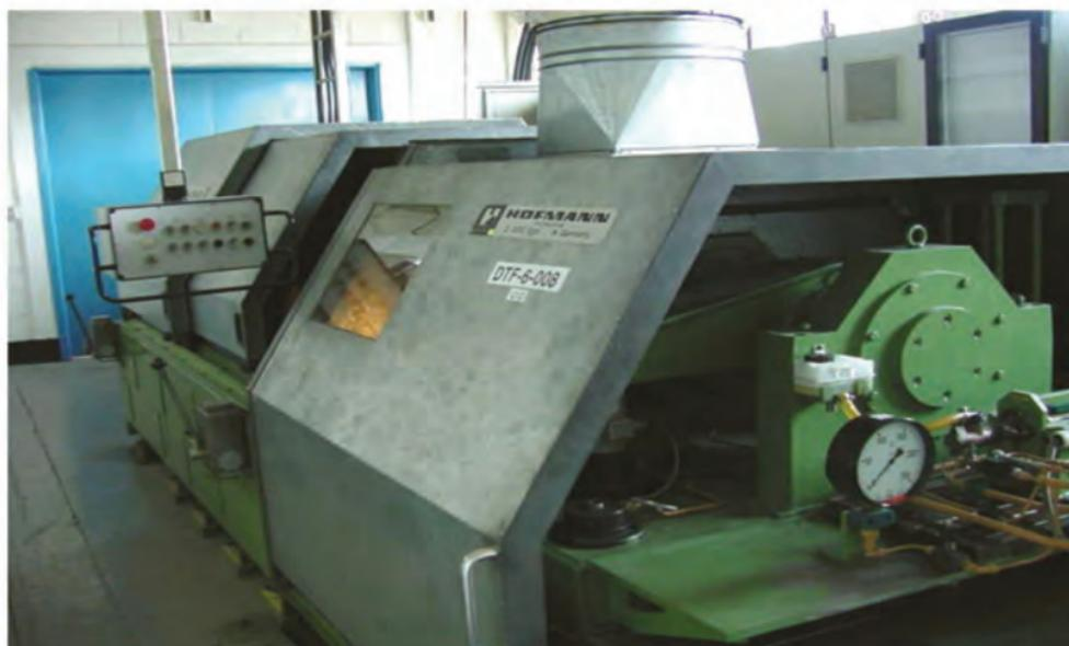
La actualización de este equipo consistió en cambiar un controlador lógico programable por una computadora de tipo industrial y desarrollar el *software* de control y captura de datos, así como la incorporación de una cámara de video para aumentar la seguridad de quien hace las pruebas.
