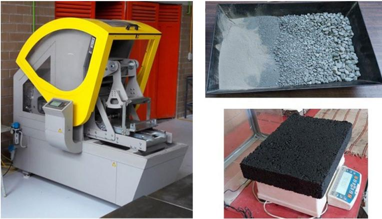
Figura 6 Compactador lineal
