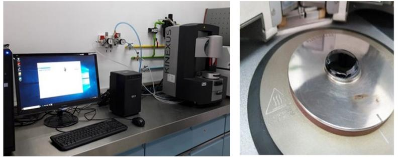
Figura 2. DSR, Reómetro de corte dinámico
