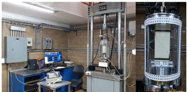
Figura 11. Marco de carga MTS para determinar el comportamiento mecánico de suelos y mezclas asfálticas
