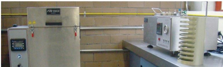
Figura 4. PAV, Horno de envejecimiento a presión
