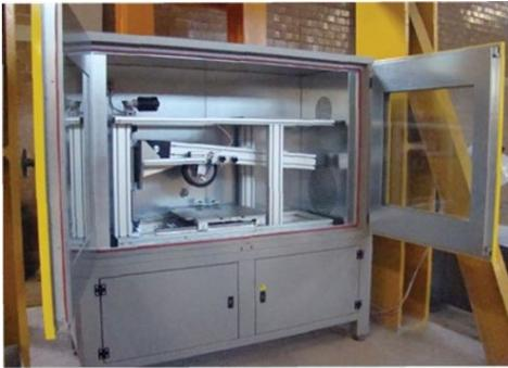
Figura 7. Rueda de carga española para determinar la susceptibilidad a la deformación de la mezcla asfáltica
