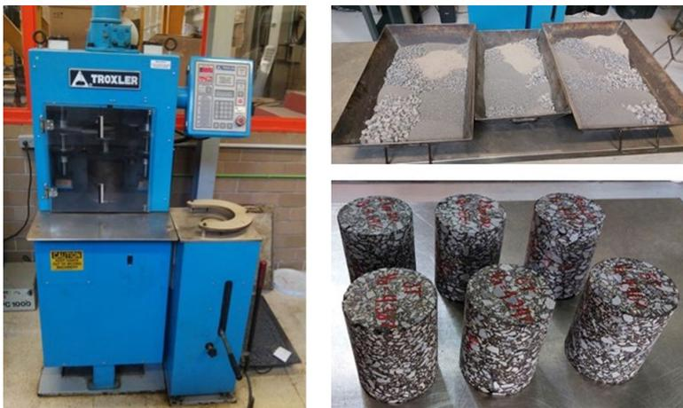
Figura 5. Compactador giratorio SUPERPAVE
