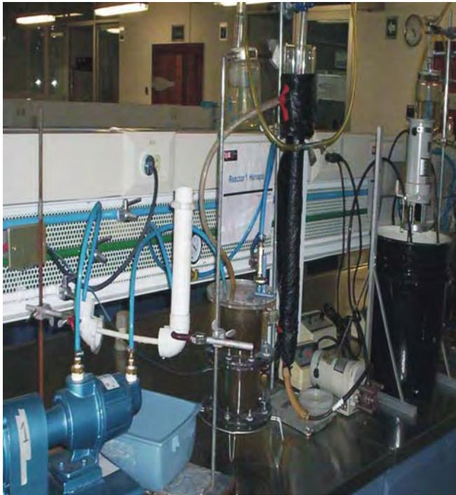
Montaje experimental del reactor anaerobio con membrana
