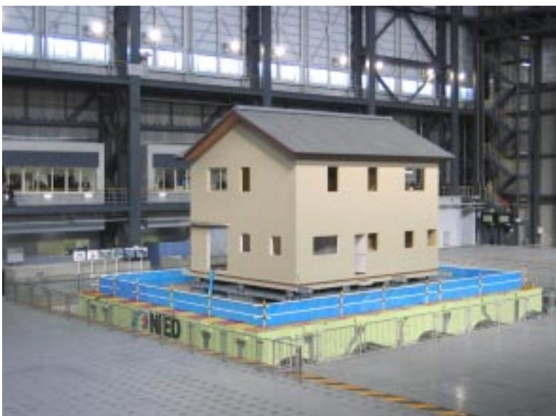
Vivienda de madera ensayada bajo el registro de Kobe de 1995 (aceleración máxima del terreno NS de 821 cm/s<sup>2</sup>, EO de 619 cm/s<sup>2</sup> y de 333 cm/s<sup>2</sup> en la dirección vertical)
