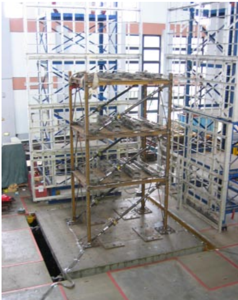
Ensaye en mesa vibratora de un marco metálico con dispositivos de control activo en NCREE
