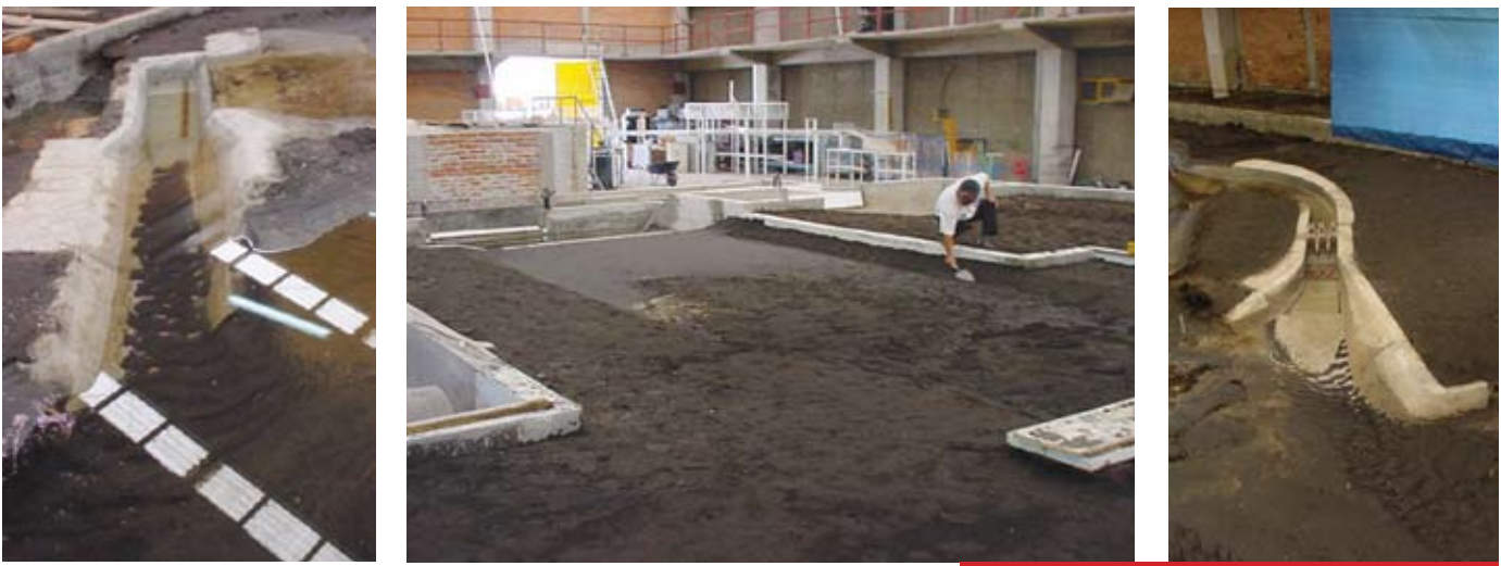
Fig 2. Modelo físico a escala 1:60 de la obra de control
