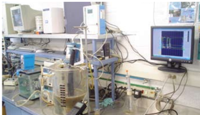
Biorreactor en el laboratorio de bioprocesos ambientales. Opera con una estrategia de control desarrollada por el grupo
