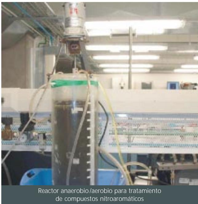
Reactor anaerobio/aerobio para tratamiento de compuestos nitroaromáticos
