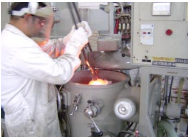
Retiro del crisol de la matriz del horno de inducción del IIM-UNAM
