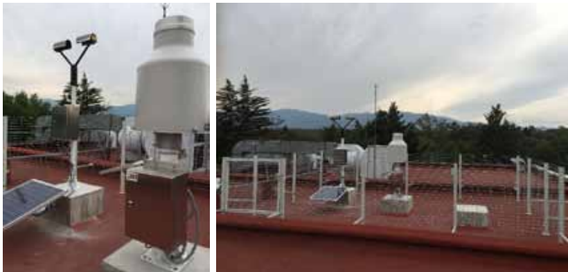
Figura 1. Panel izquierdo: acercamiento de disdrómetro láser y pluviómetro de pesaje; panel derecho: perspectiva de la instalación en la azotea del edificio 5.
